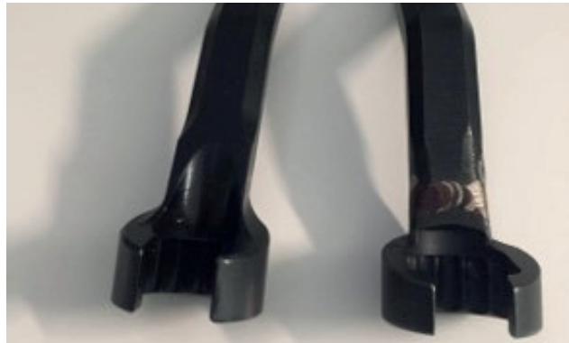
Fertigung und Optimierung von einer mechanischen Ölleitungsverschraubung für die Automobilindustrie. Vorher: geschweißt, Bruchstellen vorgegeben, Standzeit ca. 800 St. Verschraubungen. Nachher: nicht geschweißt, Verbesserung der Konstruktion, Standzeit: ca. 20.000 St. Verschraubungen, hohe Kosteneinsparung durch ProfiOrga.
