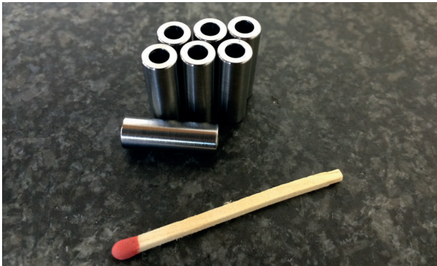
Fertigung von Verbindungsstücken aus „Memorymetall“ für Versuchszwecke in der Luftfahrt.
